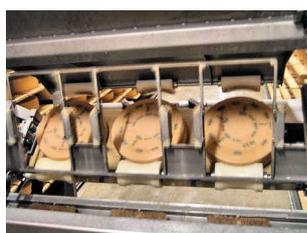
Das Verfahren hat sich besonders durch eine enorme Kontinuität der Schmierqualität bewiesen, das bei einem Manuellen schmieren nie erreicht wurde. Bürstzeit sowie Schmierflüssigkeitsmenge sind regulierbar. Es kann zwischen Kreislauf- und Verloren-Schmieren gewählt werden.
